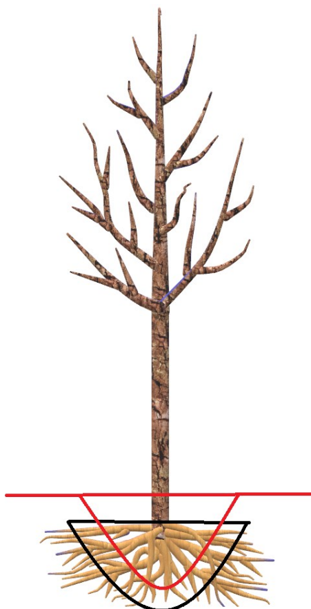
Rys. 17. Kolorem czerwonym zaznaczono bryłę korzeniową, która powstanie w przypadku nadsypania gruntu na odziomek. Kolorem czarnym zaznaczono prawidłowy obrys bryły korzeniowej bez nadkładu ziemi.
